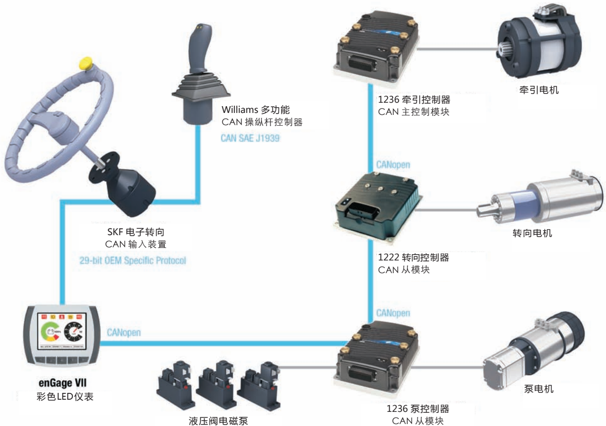
上图：配备有VCL的Curtis 交流电机控制器可以将不同的协议“翻译”成一种共同语言
